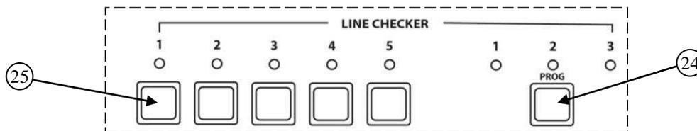
Блок контроля предназначен для дистанционного и автоматического контроля линий громкоговорителей, путем измерения импеданса линии и сравнения его с запомненным значением. При отклонении импеданса от запомненного значения на 10% происходит срабатывание. Индикация неисправности осуществляется световым, звуковым способом и замыканием контактов RELAY на задней панели (поз. 9).
