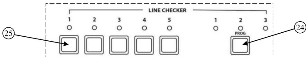
Блок контроля предназначен для дистанционного и автоматического контроля линий громкоговорителей, путем измерения импеданса линии и сравнения его с запомненным значением. При отклонении импеданса от запомненного значения на 10% происходит срабатывание. Индикация неисправности осуществляется световым, звуковым способом и замыканием контактов RELAY на задней панели (поз. 9).
