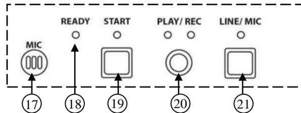
Модуль цифровых сообщений предназначен для автоматического аварийного оповещения. Блок позволяет записывать и хранить в цифровом виде одно речевое сообщение длительностью до 60 секунд.
